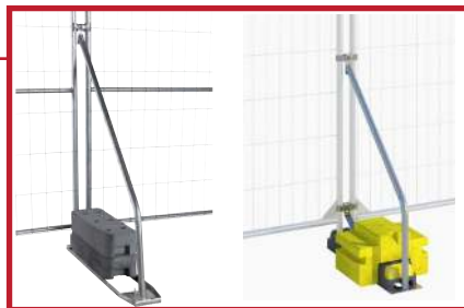
Støttestag klikk (til venstre) er et solid stag der selve "stangen" klikkes på plass i en festeplate. Støttestag for ballastblokk brukes sammen med gul fot, løftesikring og ballastblokk på hele 50 kg. Bygger kun 69 cm ut fra gjerdet.
