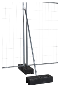
Støttestag m/plate og fot som motvekt. Staget festes med klammer.
