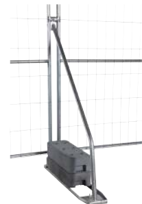
Støttestag click og fot som motvekt. Staget festes med klammer.
